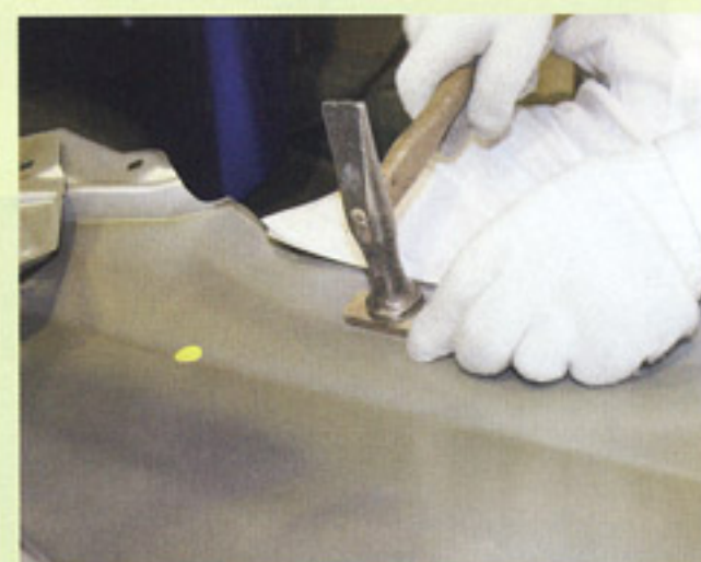
10 パネルを裏返し損傷部の深い部分に木片を当て、その上からならしハンマーで叩く。
