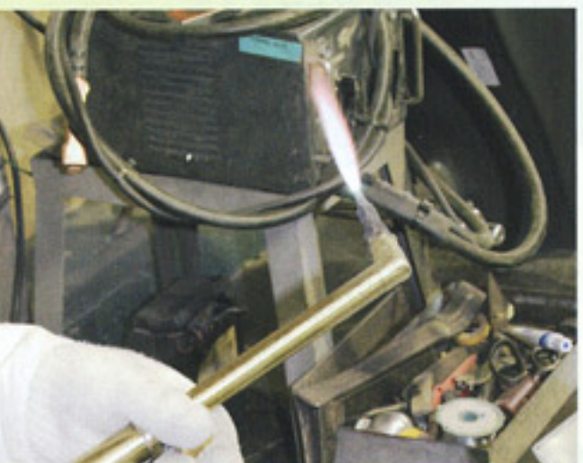
5 この部分はし字状で強度があることから、凹みを修正する際に同社ではガス溶接器を使用して、短時間かつ局所的に加熱する。
