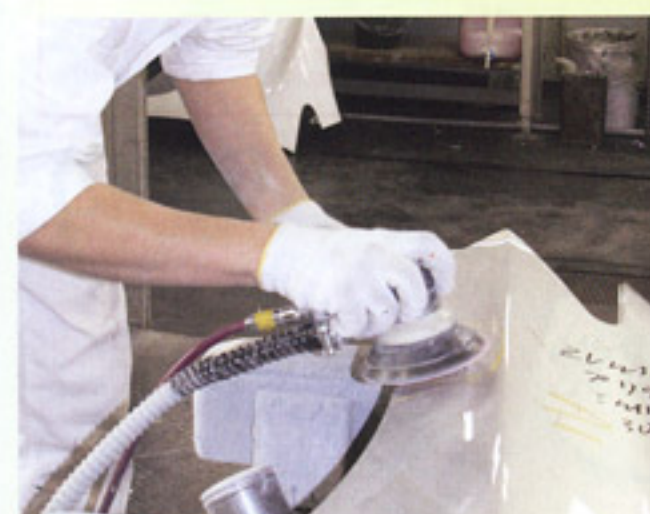
15 吸塵式のダブルアクションサンダーを使用し、ペーパーP80→120の順でフェザーエッジを作る。
