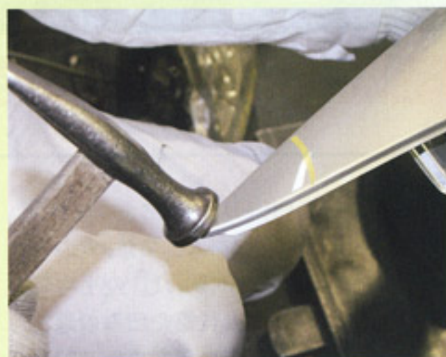
2 ゆがみは外に向かって2mmほど広がっていた。ならしハンマーで内側に数回叩く。その後、再びヘッドライトを当ててゆがみが取れたか確認し、完了。
