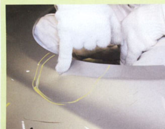
9 タイヤハウス真上のプレスラインの凹みを修正する。ここでは型紙がないため、引き出す際の高さを目分量で決める。
