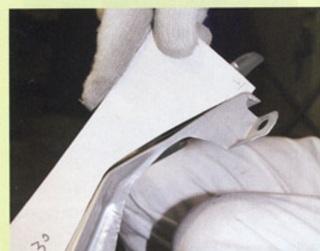
3 フロントドア上部との隣接部分の深さ5mmほどの凹み傷を修正する。ここでは、ボール紙で作った同型車の型紙をパネルに対して垂直に当て、ダメージの程度を確認。
