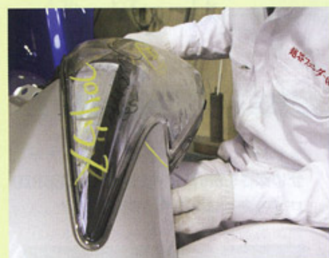
1 ヘッドライト上部のゆがみを修正するため、同型車のヘッドライト（ランプなしの確認用）を当ててダメージの状態を確認する。
