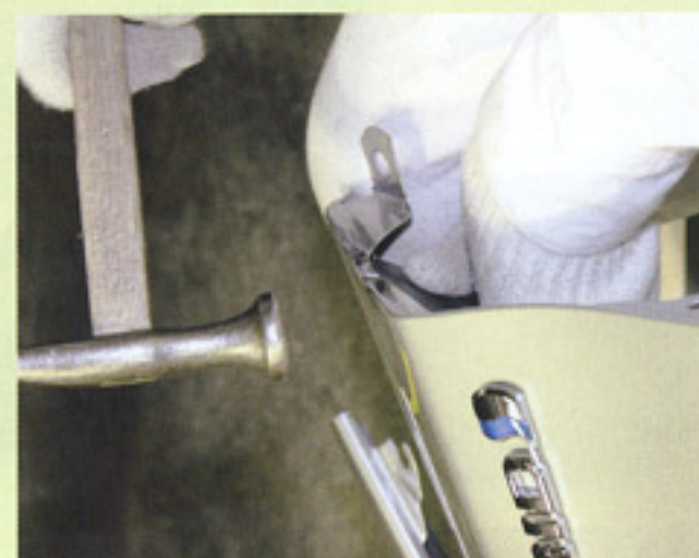
7 パネルの裏に刃が半円状になったタガネをあて、表面をならしハンマーで叩く。凹みが正常な高さまで戻れば叩くのをやめる。
