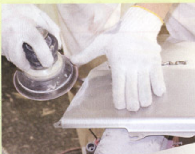
14 グライNDERで、さらにパネル表面の塗膜を剥がす。
