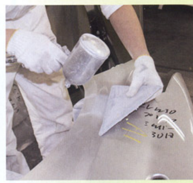
15 吸塵式のダブルアクションサンダーを使用し、ペーパーP80→120の順でフェザーエッジを作る。
