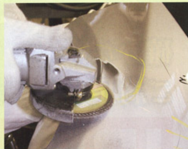
14 グライNDERで、さらにパネル表面の塗膜を剥がす。
