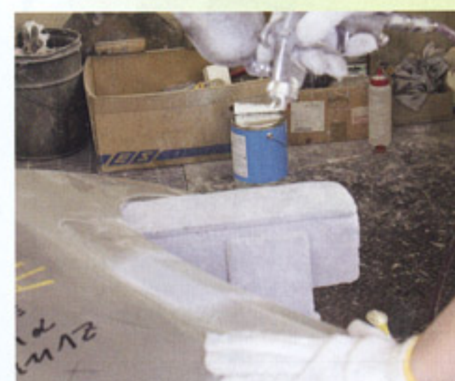
16 プラサフ塗布。マスクは時間がかかるため、三角形の板を使用し周囲をカバーしている。
