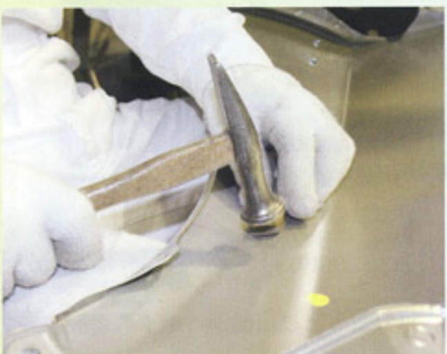
11 次にタイヤハウスのカーブと平行に走るラインの輪郭に木片を当てならしハンマーで叩く。ラインをつぶさないように注意する。
