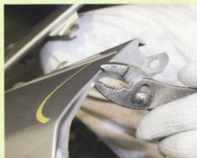
4 まずは、プライヤーを使いパネル端の合わせ目の凹みを粗出しする。
