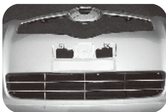
歪みが発生しているヶ所
