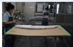
改善：バンパーの補修作業台の上に厚手の段ボール版を置いて作業することで、補修が終わった商品をその場で梱包ができるようになった。
