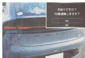
トヨタ自動車が開発した交通トラブルにつながりやすい「あおり運転」に備えた先進安全装置は、後方車両が異常接近した際に警察への通報をドライバーに提案する機能です。リアバンパーの後方ミリ波レーダーで後方車両を監視し、異常接近時にドライブレコーダーで自動録画するとともに警察への通報をドライバーに提案するものです。既にレクサスで搭載済みですが今後は量販モデルにも拡大するとの事です。自衛目的でドライブレコーダーの搭載は増えていますが、自動録画や通報提案など一歩進んだトヨタの機能により、ドライバーの安心感がより一層増しそうです。(日刊自より抜粋)
