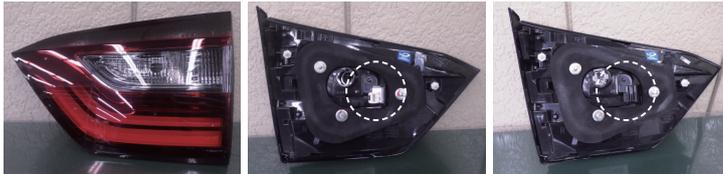
HV車 GR3      HV車、コネクタの位置      ガソリン車 GR1
