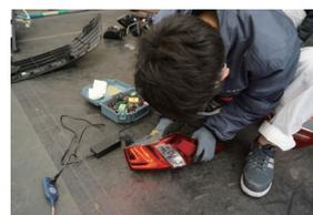
LEDランプの出荷前点灯試験はH28.4から開始し4年目を迎えています。令和元年度は3,300点の出荷数に対して、点灯不良によるクレーム件数は1件とほぼ圧征した状況です。リノベートパーツが安心して使うことができるようにこれからも努力してゆきます。
