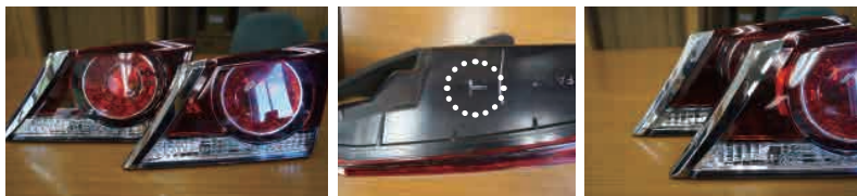
手前奥 TBO車 NA車 刻印Tの位置 手前 スモークメッキ枠 メッキ枠
