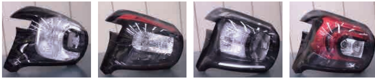
前期ハロゲン車① 前期LEDランプ車② 後期ハロゲン車③ 後期LEDランプ車④
